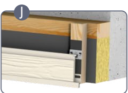
J Profil nadproża L=3m + taśma dystansująca UNI 6x9mm L=15m
